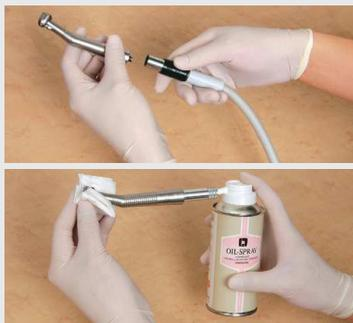
カップリングからタービン本体を外し、上図のように専用のスプレーオイルを注油します。
