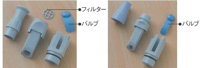
写真のように本体を分解し、溜まったゴミの洗浄を行ってください。バルブ以外はオートクレーブ滅菌が可能です。
