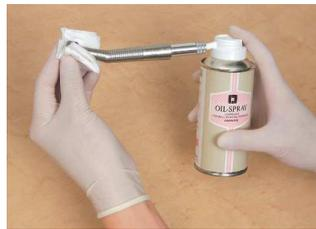
カブリングからタービン本体を外し、上図のように専用のスプレーオイルで注油します。
