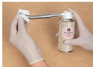
カブリングからタービン本体を外し、専用のスプレーオイルで注油します。
