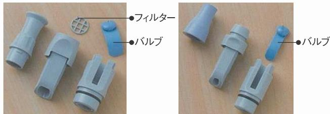
写真のように本体を分解し、溜まったゴミの洗浄を行ってください。バルブ以外はオートクレーブ滅菌が可能です。
