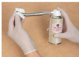
カプリングからタービン本体を外し、上図のように専用のスプレーオイルを注油します。
