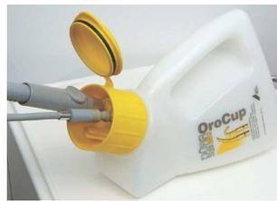
タカラベルモントのユニット専用洗浄液オロトルプラスを使用し、バキュームHPと排唾管を挿し込み吸引させます。
