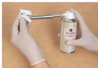
カプリングからタービン本体を外し、専用のスプレーオイルで注油します。
