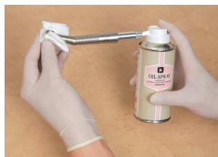
カプリングからタービン本体を外し、上図のように専用のスプレーオイルで注油します。
