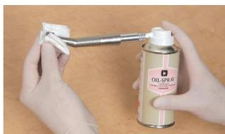
カブリングからタービン本体を外し、上図のように専用のスプレーオイルで注油します。
